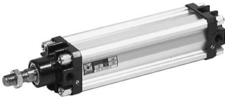
Это базовое исполнение цилиндра с непроворотным штоком. Монтажные и габаритные размеры выполнены по стандартам ISO-VDMA. Цилиндр может монтироваться на машину непосредственно или с использованием различных принадлежностей, которые приведены далее.
